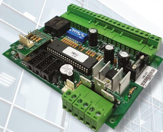
A DECC é um módulo eletrônico que controla o mecanismo de giro de catracas e bloqueios. Possui entradas para fotocélulas e saídas para as solenóides de travamento de giro, além de conectores para acionamento de pictograma que indicam liberação ou negação de passagem. Opera em modo sonoro, com buzina ou silencioso. A DECC é ideal para integração com módulos FLEX e TRIJOBS.
